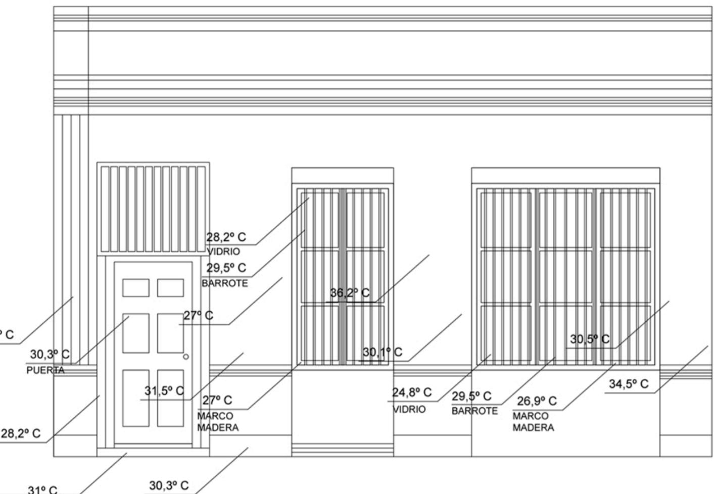
AL ANALIZAR LA FACHADA LAS TEMPERATURAS MÁS ALTAS SE ENCUENTRAN EN LA PARTE INFERIOR, ESTO ES DEBIDO AL PUENTE TÉRMICO ENTRE EL PAVIMENTO DE LAS VEREDAS Y LOS CIMENTOS DE LA VIVIENDA.
