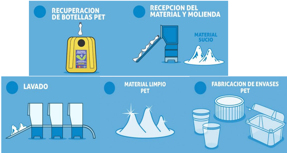
ESQUEMA DE FUNCIONAMIENTO DE REC 1 PET FUENTE: HTTP://WWW.RECIPET.CL/SISTEMA/INDEX.PHP
