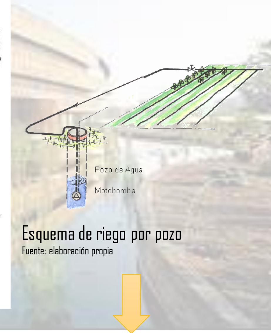
**Esquema de riego por pozo**
