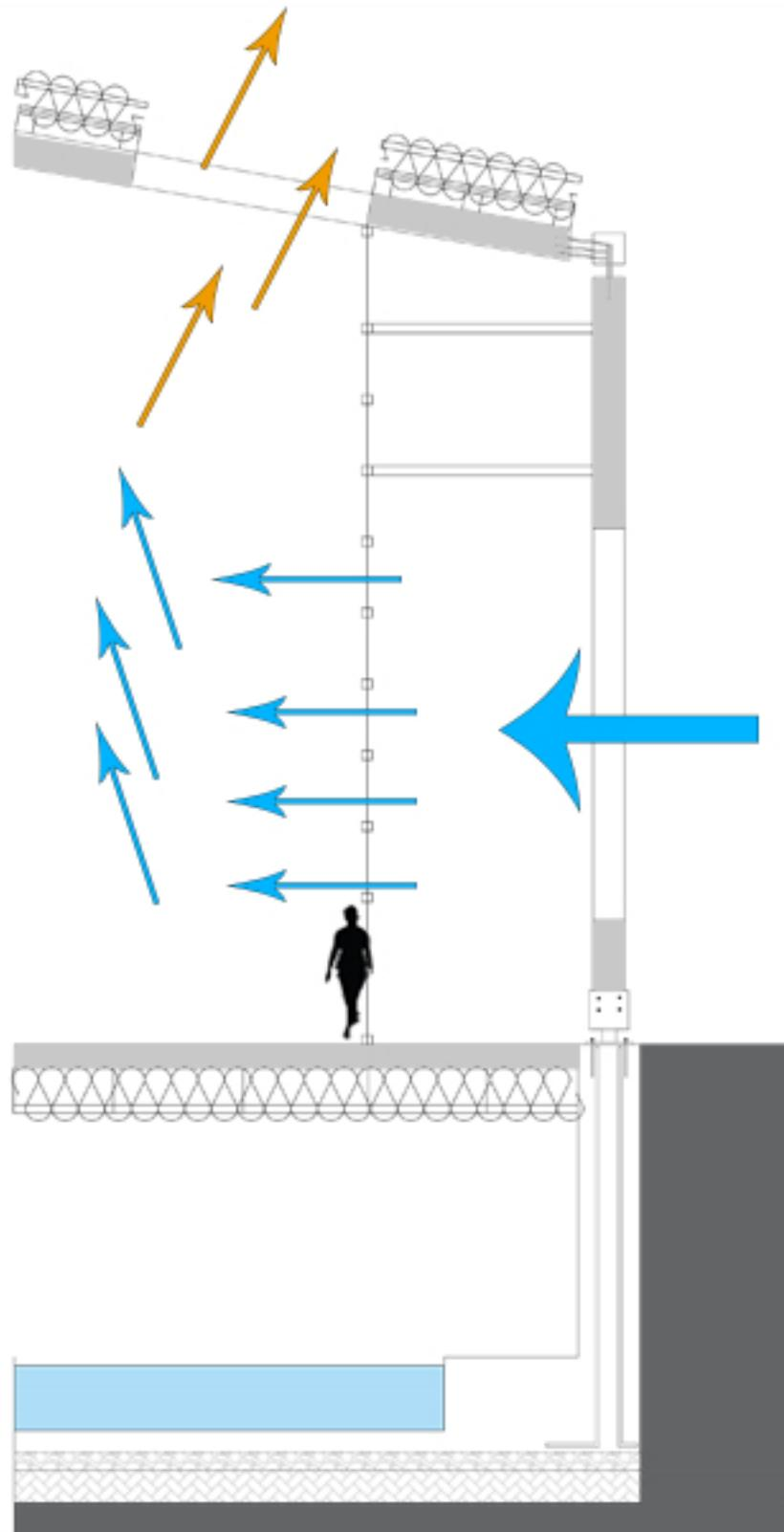
PARA ACONDICIONAR LA PISCINA, SE TRABAJÓ LA ENVOLVENTE DE MANERA QUE EXISTA UN ESPACIO AMORTIGUADOR ENTRE LA ESTRUCTURA Y EL INICIO DEL ESPACIO HABITABLE.
