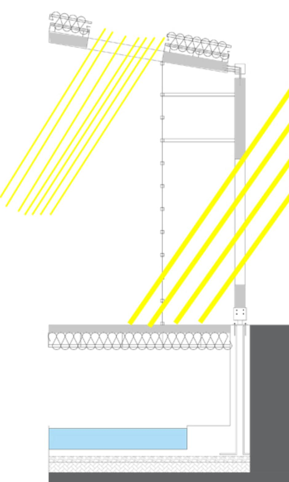
PARA AMORTIGUAR EL ASOLEAMIENTO Y PERMITIR EL PASO DE LA LUZ, SE TRABAJARON MATERIALES SEMITRASLUCIDOS EN LA TECHUMBRE, PERO TRASLUCIDOS EN LA ENVOLVENTE, Y COMO SE ENCUENTRA SEPARADO DE LA ESTRUCTURA GENERA UN EFECTO DE ALEJO, Y ASÍ PODER AMORTIGUAR LOS RAYOS SOLARES, Y DEJAR QUE PASE LA LUZ PARA EL MEJOR DESARROLLO DE LA ACTIVIDAD.
