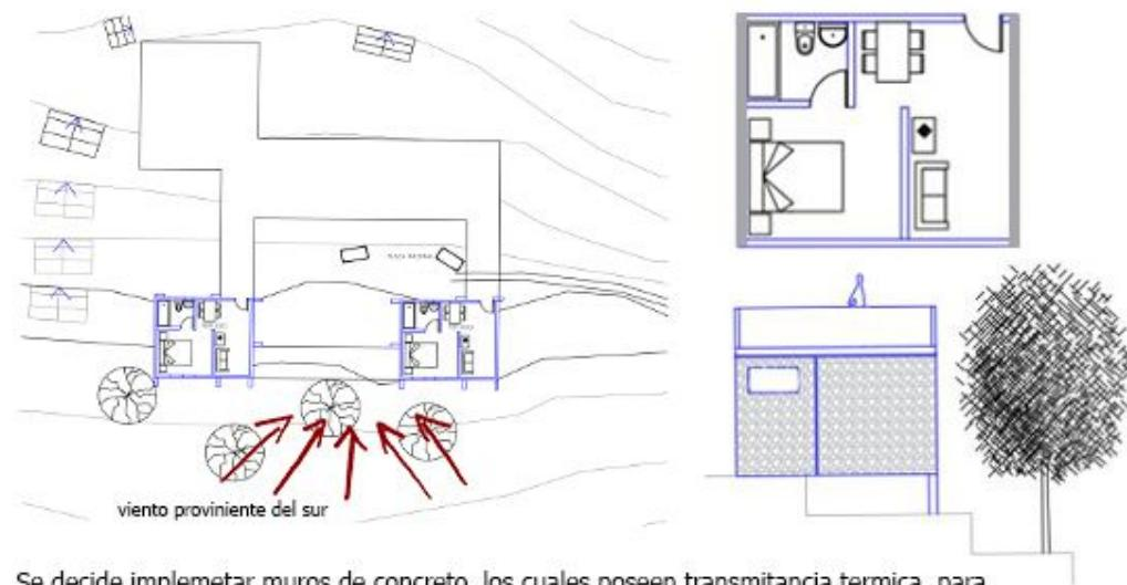
Se decide implementar muros de concreto, los cuales poseen transmitancia térmica, para aclimatizar sus interiores durante la noche y prevenir las corrientes de aire frío.
